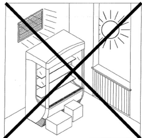
**ⓘ** Für einen optimalen Betrieb sollte das Gerät mindestens 10 cm von der Wand weg platziert werden (hinten und rechte Seite), um eine gute Luftzirkulation zu gewährleisten. Die Garantieleistung verfällt, wenn das Gerät direkt an die Wand aufgestellt wird!
